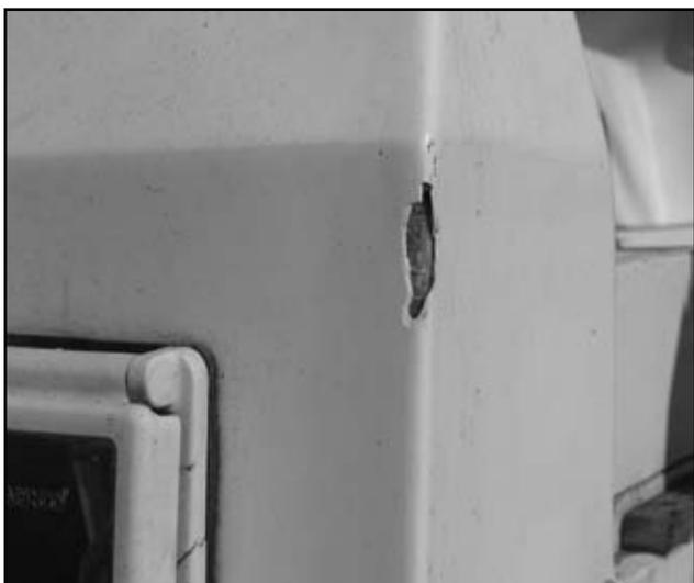
Par mégarde, si on accroche ou qu'on frappe cette poche d'air, le gel coat éclate ou il s'enfoncé. À court terme, ce n'est pas trop grave, mais à long terme, il faut les réparer parce que la fibre peut se contaminer par l'humidité qui s'emprisonne entre le gel coat et la fibre de verre. C'est toutefois une réparation qui se fait très bien.
