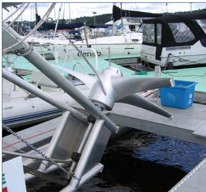
Le principe est relativement simple, le courant de rivière fait tourner l'hélice, laquelle entraîne le gros alternateur qui produit l'électricité.
