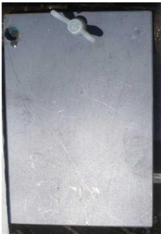
*Cette surface test en PVC sans revêtement va servir d'éprouvette. L'immersion a été réalisée entre le mois de mai et septembre.*
