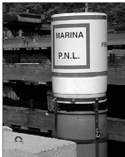
La bouée est fabriquée de deux barils de plastique superposés. L'assemblage est l'œuvre de Mario Demers. Le premier baril est lesté de béton et supporte le poids des chaînes en pleine immersion. Le second, soit la
