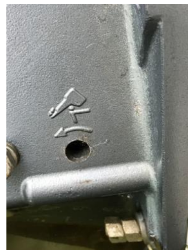
Vis de dépressurisation des vérins du trim
