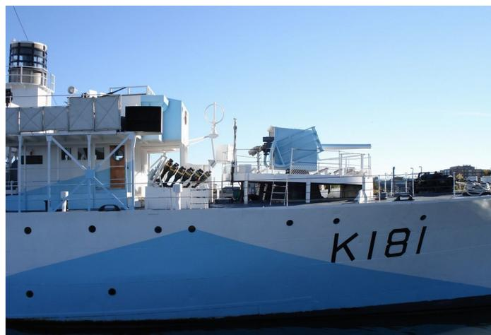
Réf: Corvette canadienne NCSM Sackville, The Canadian Naval Memorial Trust & HMCS Sackville, Halifax. Canon de 4 pouces sur le gaillard avant; Mortiers connus sous l'appellation de *Hedgehog mortar*; Passerelle ouverte à toutes les conditions de température.; Radar métrique surmontant la passerelle.
