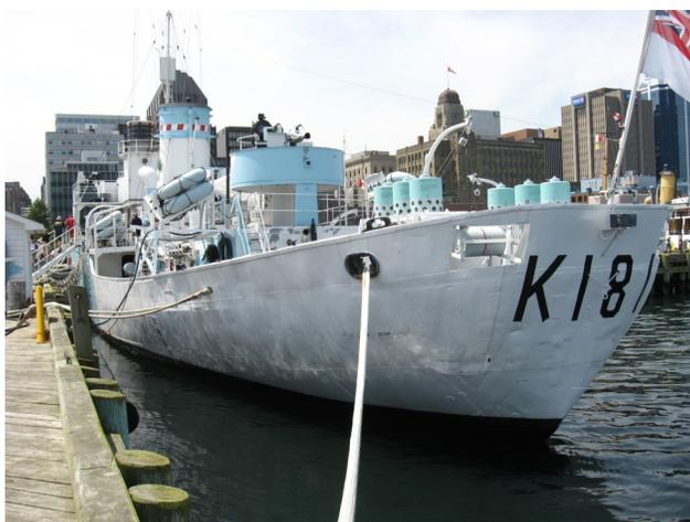
**Réf:** Corvette canadienne NCSM Sackville, The Canadian Naval Memorial Trust & HMCS Sackville, Halifax. La plage arrière et la poupe de la NCSM Sackville. Canots de sauvetage. Canon antiaérien, fumigènes et grenades sous-marines.
