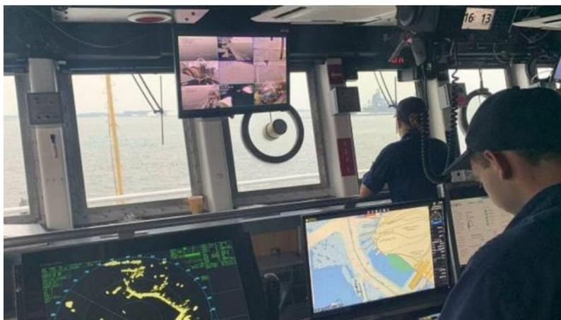
À bord des gros bâtiments, l'Electronic Navigational Chart (ENC) est utilisée sur l'Electronic Chart Display and Information System (ECDIS). | NOAA
